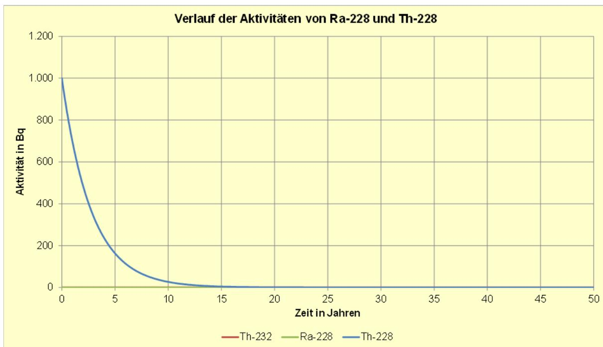
**Abbildung 27:** Verlauf der Aktivitäten von Ra-228 und Th-228 bis zur Einstellung des radioaktiven Gleichgewichts (Start Th-232 = 0 Bq, Ra-228 = 0 Bq, Th-228 = 1000 Bq)
