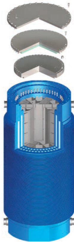
Abb. 2.1 Explosionszeichnung des CASTOR® V/19 mit PE-Moderatorstäben im Behältermantel /WIM 15/
