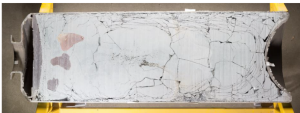
Abb. 4.6 Querschnitt einer Surrogat-Glaskokille mit Rissen in der Matrix /REP 19/
