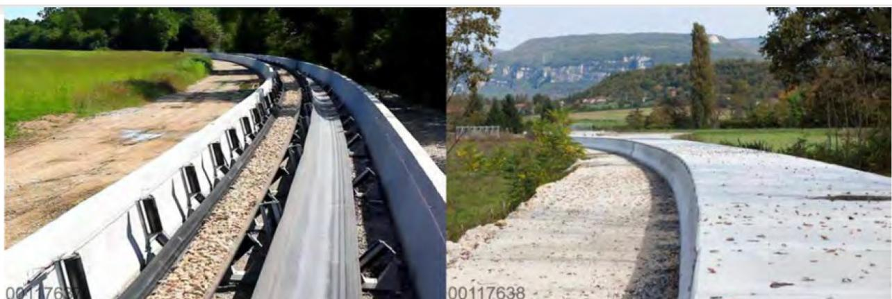
Abbildung 20: Beispiel einer eingehausten Unterflur-Bandanlage ([16], Figure 3-88)
