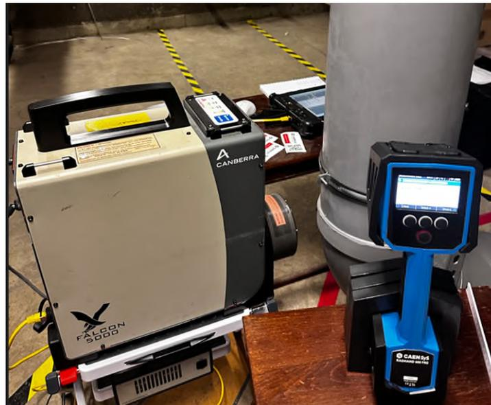
Abbildung 20: Aufbau der Messtechnik am MED-Fortluftkamin des Heißlabors.
