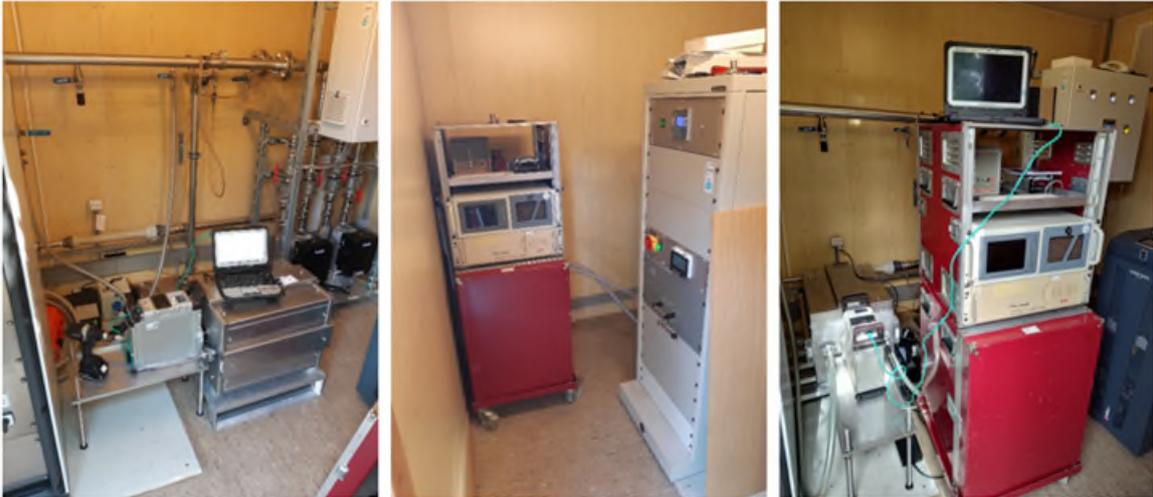
Abbildung 9: Aufbau der integralen und nuklidspezifischen Messkammern im Messcontainer von JUM. Links und Mitte: Erste Messreihe. Rechts: Zweite Messreihe.
