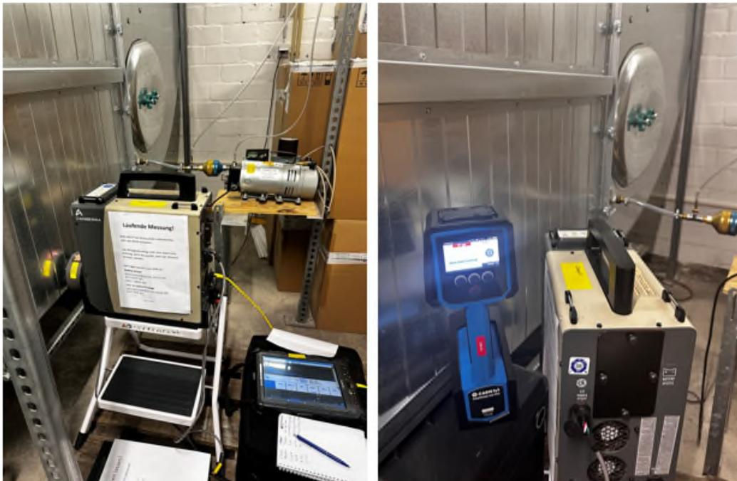
Abbildung 19: Aufbau des Falcon 5000 und des RadHAND für die Messung des Fortluftkamins der MED-Jodstation. Links: Senkrecht zum Fortluftkanal. Rechts: Unter einem Winkel von ca. 45°.
