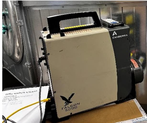
Abbildung 5: Messgerät Falcon 5000 im Messeinsatz bei MED.
