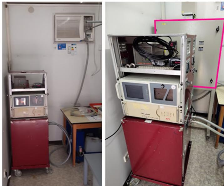
Abbildung 13: Aufbau der integralen Messtechnik im Messcontainer der FOR-Forschungseinrichtung. Links: Aufbau für die erste und zweite Messreihe. Rechts: Aufbau für die dritte Messreihe mit C-14-Sammler im Hintergrund (durch magenta-gefärbten Rahmen hervorgehoben).
