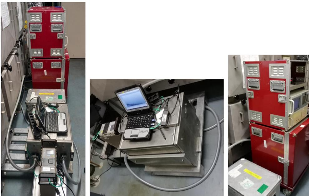
Abbildung 15: Aufbau der integralen und nuklidspezifischen Messtechnik bei IPR in zwei Perspektiven.
