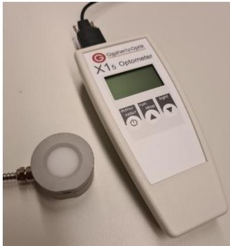
**Abbildung 4:** Verwendetes UV-Radiometer bestehend aus dem Optometer X1-5 (Seriennummer: 61624) und dem Messkopf UV-3727 (Seriennummer: 61533; beides Firma Gigahertz Optik GmbH).
