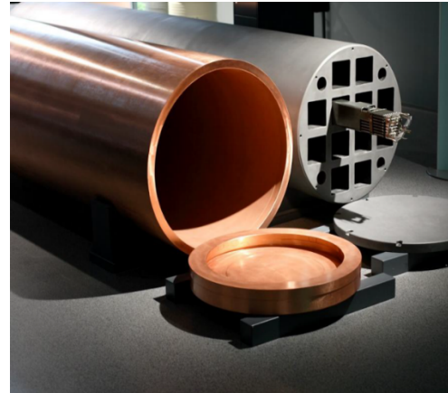
Abbildung 3: KBS-3 Demonstrationsbehälter mit Gußstahl-Innenbehälter, Außenbehälter aus Kupfer, Innen- und Außendeckel und Brennelemente Modell (SKB (2011)).
