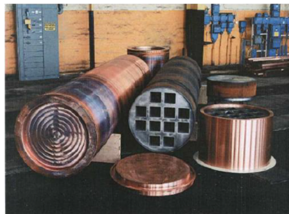
Abbildung 4: KBS-3 Behälter, gefertigte Test- und Probekörper (Andersson 1998).
