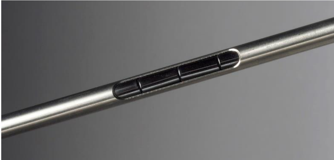
Abb. 3-4: Brennstab mit Pellets und Anschnitt der Zirkalloyhülle (The Board of Trustees of the Science Museum 2025)
