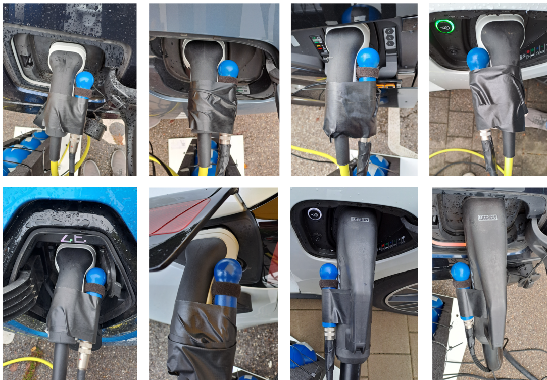
Abbildung 8.4: Anordnung des 3 cm 2 Messaufnehmers direkt am Ladestecker.
