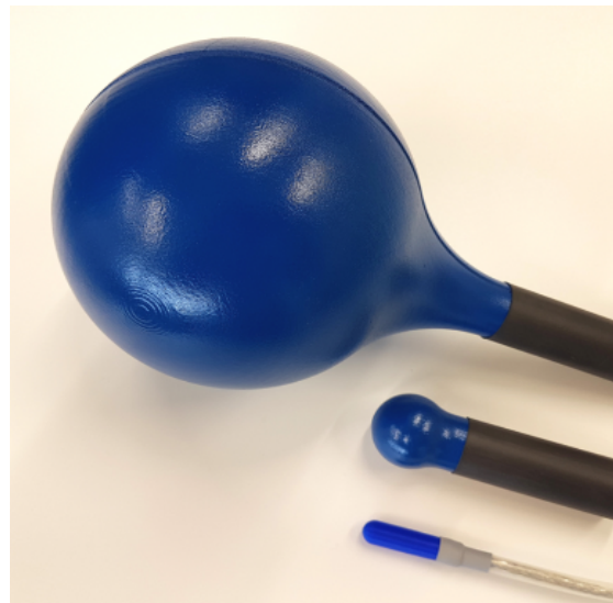
Abbildung 3.5: Unterschiedliche verfügbare MF EASY Sondengrößen: oben: 100 cm 2 Spulen + Hall; Mitte: 3 cm 2 Spulen + Hall; unten: 10 mm Durchmesser (Hall).
