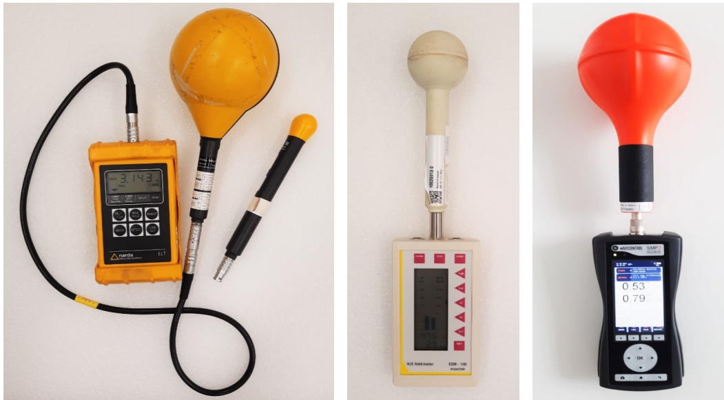
Abbildung 3.2: Drei gegenwärtig weit verbreitete und etablierte Kompaktmessgeräte zur Erfassung von magnetischen Feldern im Frequenzbereich von wenigen Hz bis 400 kHz: ELT-400 (links, abgebildet mit über Verlängerungsleitung angeschlossenem 100 cm 2 Messaufnehmer und ebenfalls abgebildetem 3 cm 2 Messaufnehmer), ESM-100 (Mitte) und SMP2 mit 100 cm 2 Messaufnehmer WP400 (rechts).
