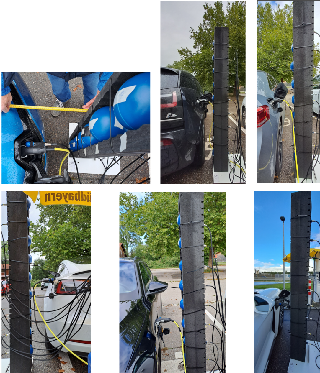
Abbildung 8.2: Anordnung der Messaufnehmer bei den Messungen in 30 cm Distanz zu den Ladebuchsen der Fahrzeuge.
