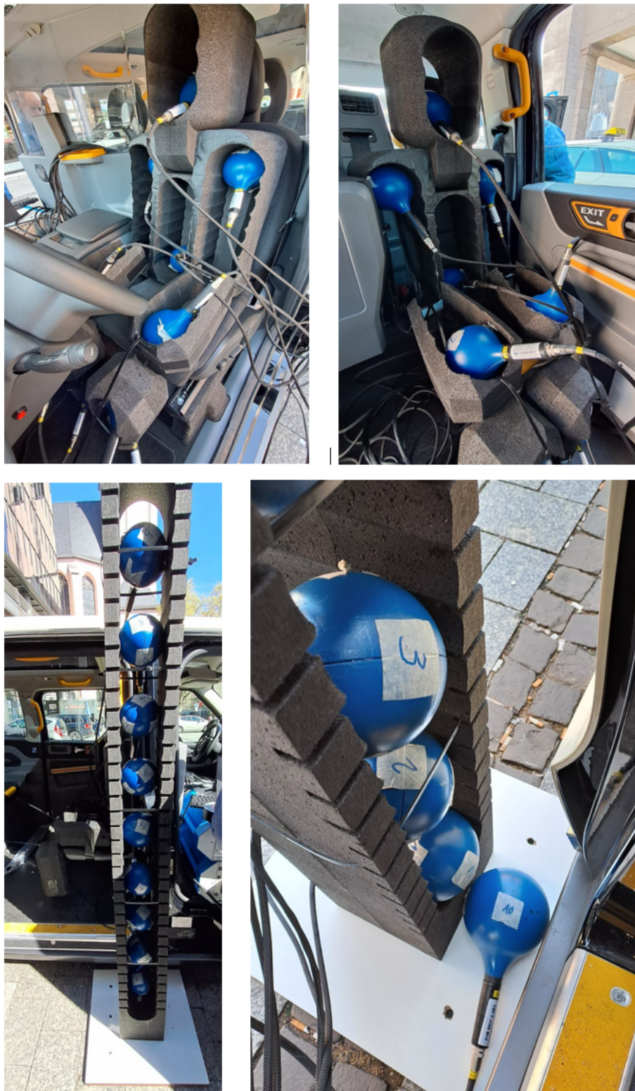
Abbildung 8.8: Platzierung des Hartschaum-Dummys am Fahrerplatz (oben, links) und am untersuchten Sitzplatz der zweiten Sitzreihe (oben, rechts). Vertikalanordnung der Messaufnehmer für die Messungen außerhalb des Fahrzeugs (unten).
