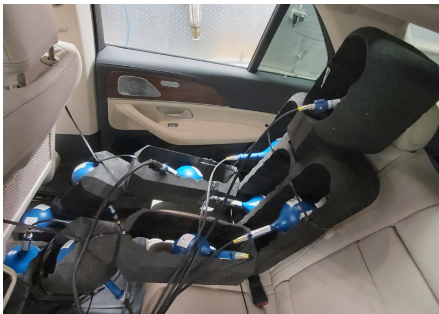
Abbildung 8.6: Hartschaum-Dummy mit Messaufnehmern auf der Rückbank eines Fahrzeuges.
