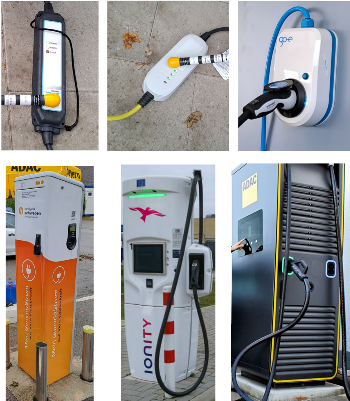
Abbildung 7.1: Untersuchte Ladepunkte: 220V AC In-line Steuergerät des Renault ZOE und des Porsche Taycan (oben, links und Mitte), 3 x 400 V AC, 11 kW Go-e Charger Wallbox (oben rechts), 3 x 400 V AC, 22 kW Erdgas Schwaben Ladesäule (unten, links), 350 kW DC Ionity Ladesäule (unten, Mitte) und 300 kW DC Alpitronic Ladesäule (unten, rechts).
