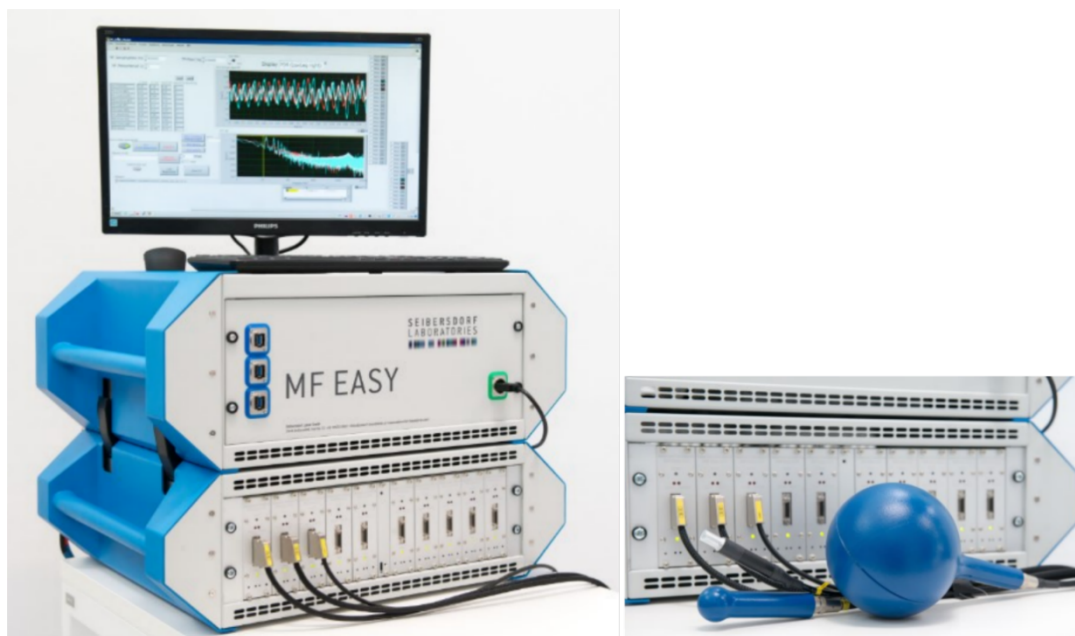
Abbildung 3.7: Das weiterentwickelte und in einem neuen, zweiteiligen Gehäuse untergebrachte MF EASY wurde schlussendlich für die weiteren Messungen verwendet ( https://rf.seibersdorf-laboratories.at/products-services/products/mf-easy ).
