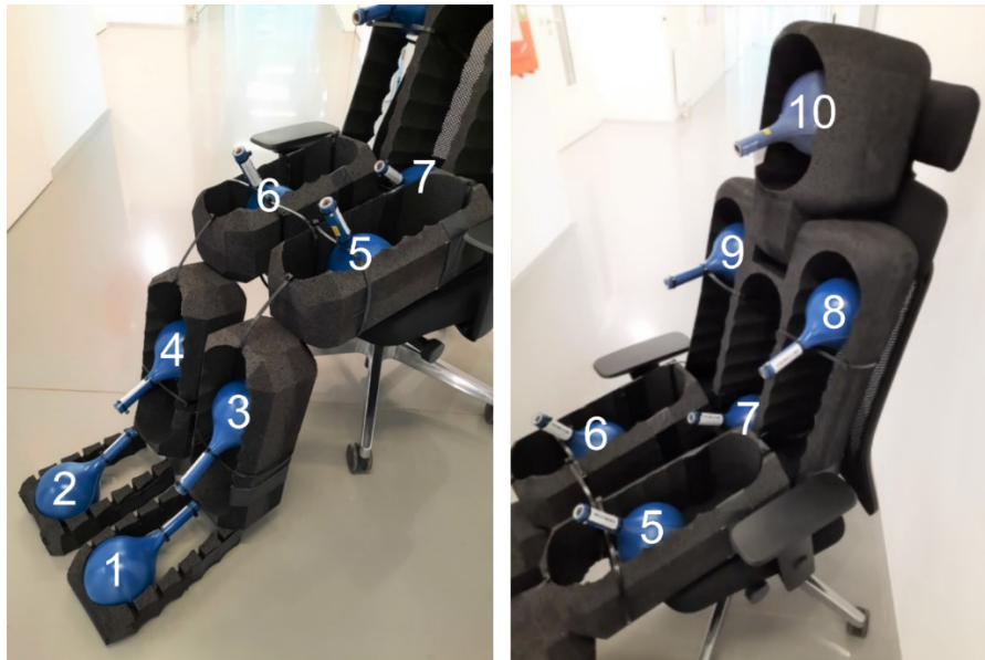
Abbildung 8.5: Hartschaum-Dummy zur Fixierung der Messaufnehmer (Messaufnehmer aus Gründen der Übersichtlichkeit ohne Kabel dargestellt).
