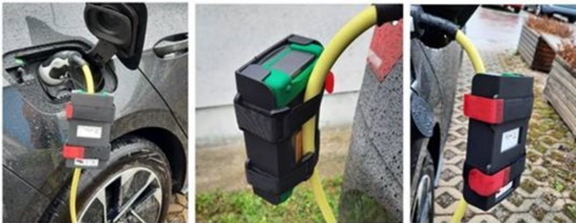
Abbildung 6.1: Fixierung des Messgerätes ExpoM-ELF am Ladekabel zur Erfassung des Verlaufs der magnetischen Flussdichte und deren spektraler Zusammensetzung im Verlauf des Ladevorganges.
