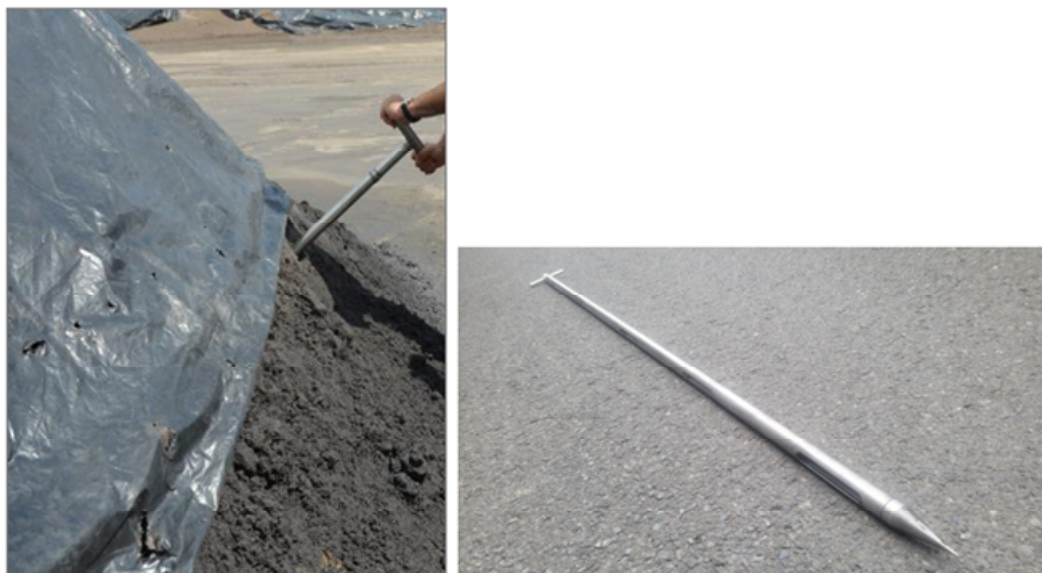
Abbildung 5-5: Links: Probenahme aus einem Haufwerk mit einem Probenstecher; Rechts: Probenstecher mit seitlicher Schlitzöffnung
