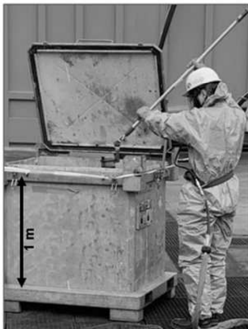
Abbildung 5-13: 1-m 3 -Container mit schlammigen Rückständen
