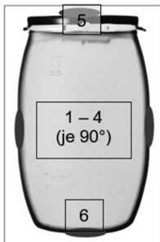
Abbildung 5-21: Lage und Kennzeichnung von Mess- und Probenahmepunkten auf der Außenseite von Fässern (60 oder 120 L Volumen)
