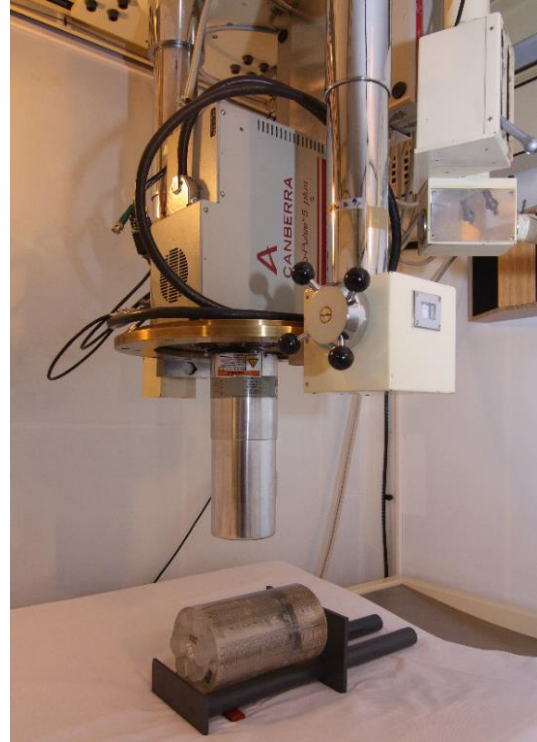
6 Ganzkörperzähler. Detektor über dem Halsphantom zur Schilddrüsenkalibrierung.
