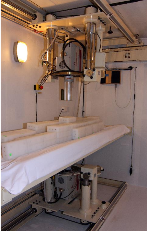
5 Ganzkörperzähler mit Kalibrierphantom (70-kg-Konfiguration).
