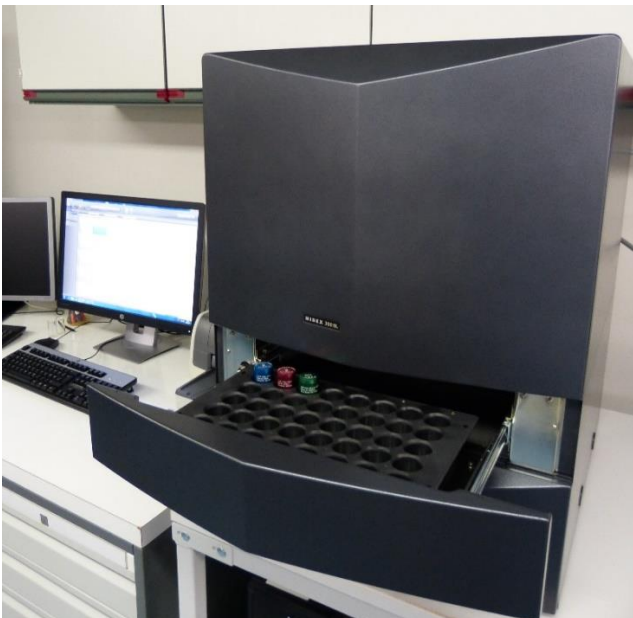
10 Flüssigszintillationsspektrometer Hidex 300 SL und Auswerterechner. In der geöffneten Probenkammer stehen die zertifizierten Standards für die Qualitätssicherung.
