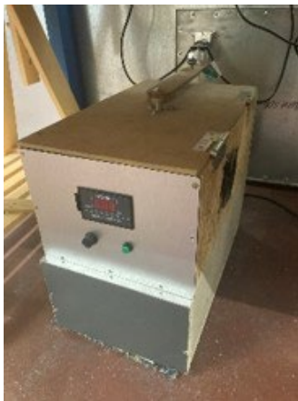
Abbildung 2.8: Motorbox mit PWM -Controller zur Bewegung der Zeltwände.
